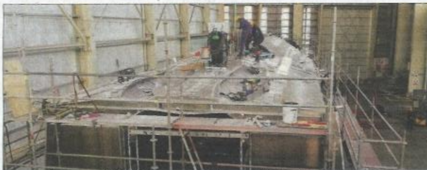
Un momento de la construcción del Río Arlanza en este astillero, especializado en buques de aluminio. eca
